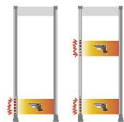
Multizónová detekcia so zobrazením polohy zbrane na líniovom displeji
