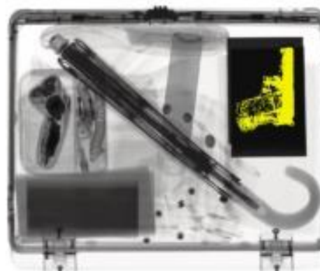
Príklad automatickej signalizácie kovového predmetu s vysokou absorpciou (nastaviteľná úroveň signalizácie)
