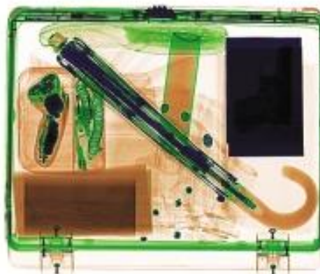
Farebný obraz s rozlíšením materiálov: oranžová farba pre organické materiály, modrá pre anorganické, zelená pre zmiešané.
