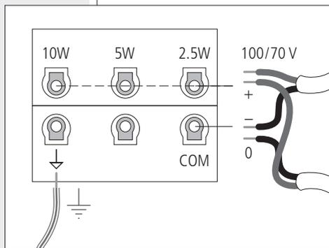
Collegando il diffusore acustico ad una linea a tensione costante 70 V, la potenza si dimezza.
