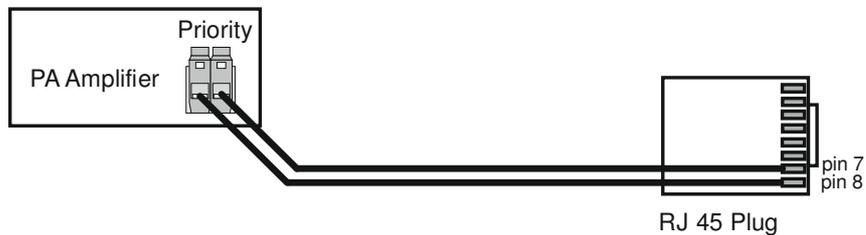
Fig. 5 – Priority wiring
