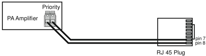
Fig. 5 – Priority wiring
